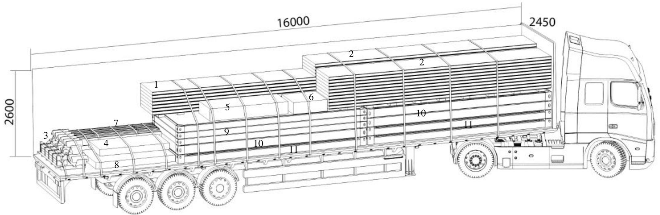
**Толщина панелей 120 мм (1-ый вариант) - Автомобиль типа «Еврофура 13,6 м + ГАЗон NEXT-фермер»**
