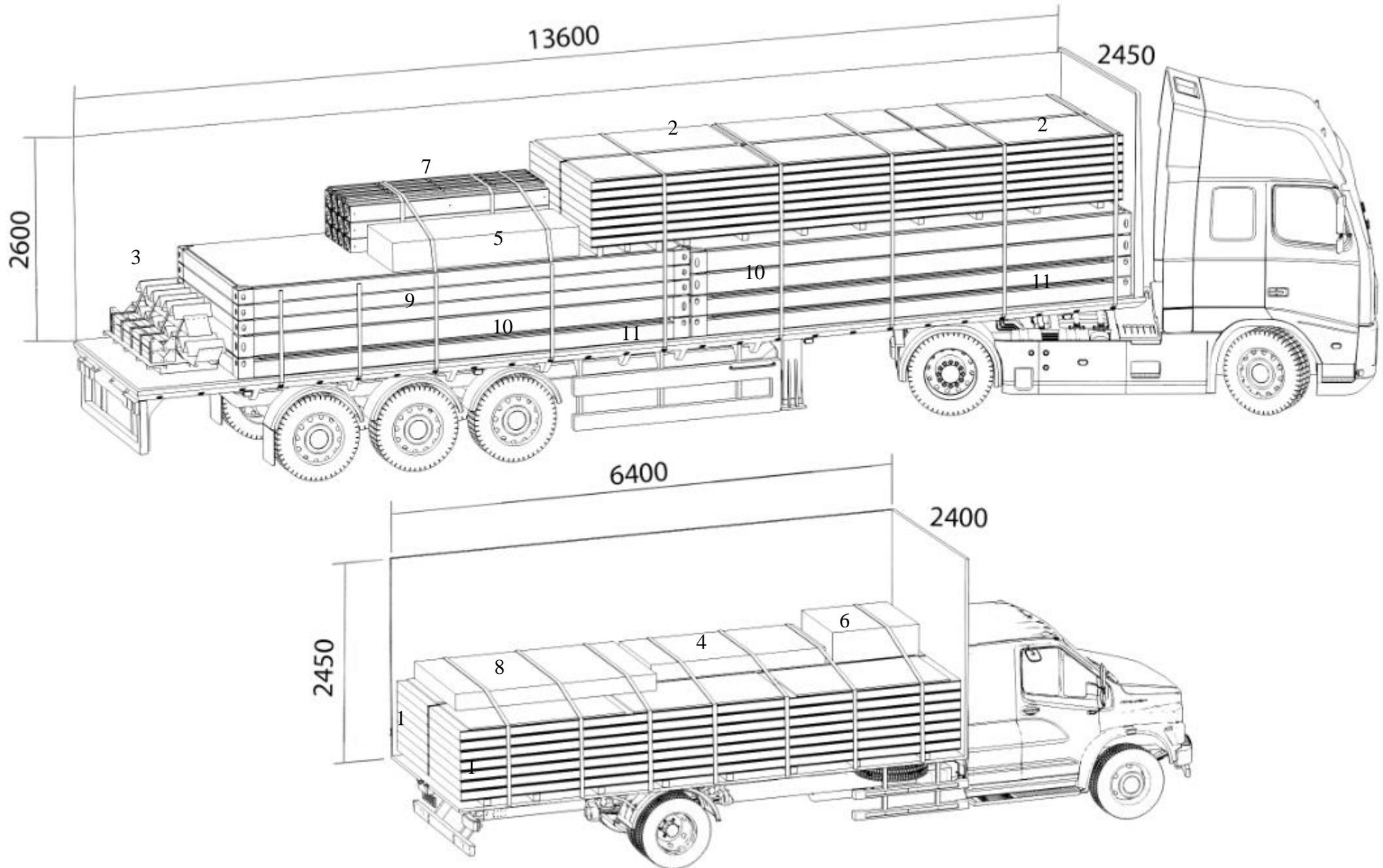
**Толщина панелей 120 мм (2-ой вариант) - Автомобиль типа «Еврофура 16 м»**
