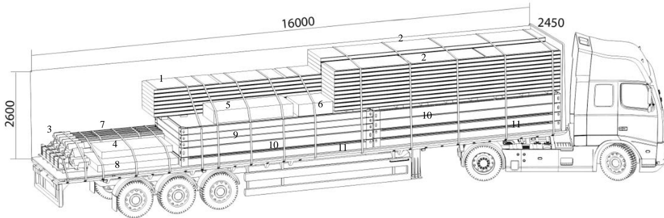
**Толщина панелей 150 мм (2-ый вариант) - Автомобиль типа «Еврофура 16 м»**
